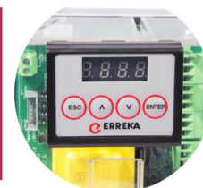
Cuadro INVERTER con programación por display
